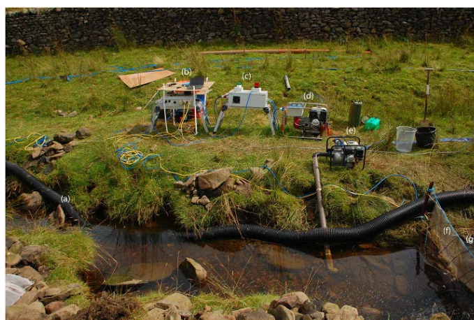
Figuur 6.6: Veldexperiment met apparatuur voor het toedienen van elektrische schokken aan een beek (uit Peay et al. , 2015).
